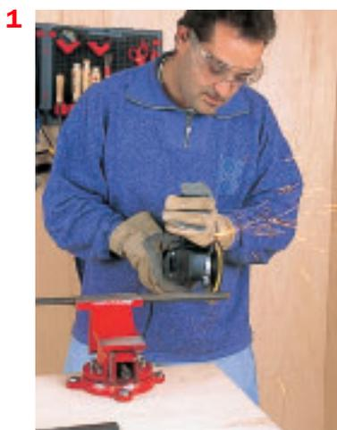
4. ... puis repasser le disque sur la rainure en traversant la tôle.
